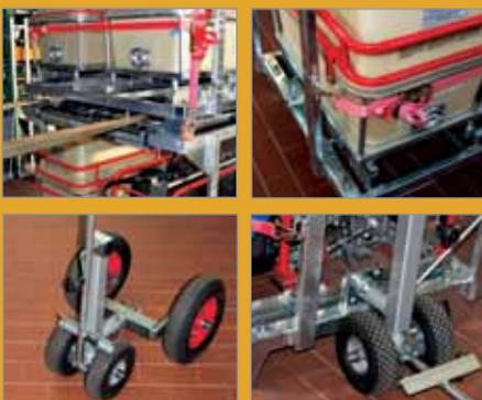
Die Hochdruckpumpeneinheit mit Dieselmotor, der Wassertank und der Schaummittelkanister sind durch das hochwertige Transportgestell als komplexes System leicht zu transportieren.
